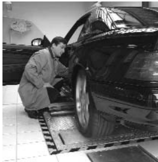
Проверка на вибрационном стенде
